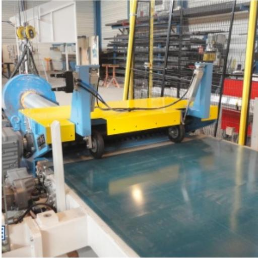
**Broyeur de plaque polystyrène jusqu'à 120mm en densité 35kg/m<sup>3</sup>.**
