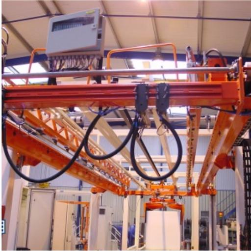
**Mise au pas des fils automatique et découpe verticale multi-fils.**
